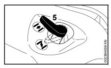
placer le levier (5) du volet de starter en position
