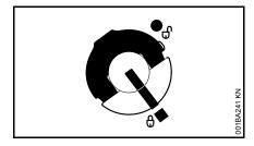
Le bouchon de réservoir est verrouillé.
