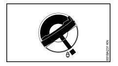
Après cela, les repères du réservoir et du bouchon du réservoir coïncident.
