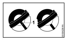
À la partie inférieure du bougauche : chon du réservoir est décalée – le repère intérieur (1) coïncide avec le
