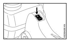
Actionner le bouton d'arrêt en direction de 0 – après son relâchement, le bouton d'arrêt revient dans la position de marche normale I, sous l'effet de son ressort.
