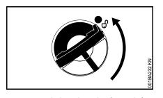
tourner le bouchon du réservoir à carburant (env. 1/4 de tour);
