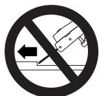
Ne pas utiliser la machine pour un meulage de côté ou un dégrossissage.
