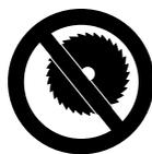
Ne jamais utiliser des scies circulaires, des outils à plaquettes de carbure, des outils de désincarcération ou des outils pour le sciage du bois, ni tout autre outil denté – **risque de blessures mortelles !**
