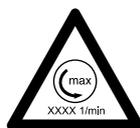
La vitesse de rotation maximale admissible pour le disque à découper doit être égale ou supérieure au régime maximal de la broche de la découpeuse à disque ! – Voir chapitre « Caractéristiques techniques ».
